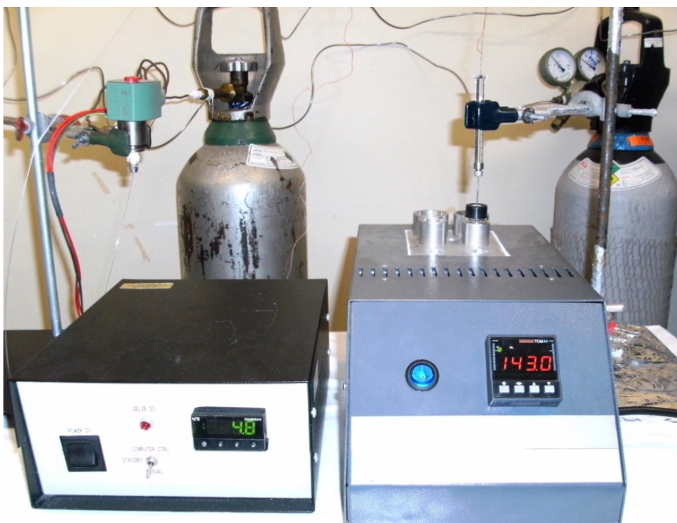
Figura 3. Foto do sistema de CF-SPME utilizado nesse trabalho. O cilindro à esquerda é o reservatório de \text{CO}_2 líquido, o qual está conectado à válvula solenóide. O tubo capilar de aço inoxidável leva o \text{CO}_2 líquido da válvula solenóide até a ponta do recobrimento. A foto mostra o dispositivo de CF-SPME inserido dentro de um frasco à temperatura de 143\text{ }^\circ\text{C} e o controlador de temperatura ao lado do bloco aquecedor mostra a temperatura do recobrimento em 4,8\text{ }^\circ\text{C} .
