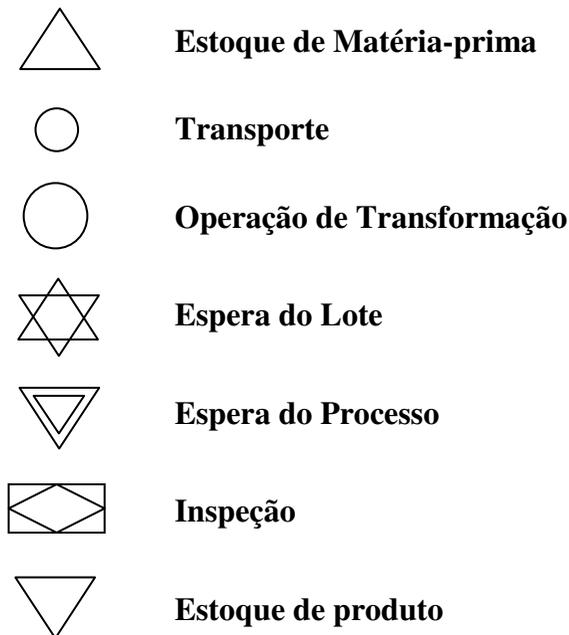
Figura 2 – Simbologia dos elementos da função processo.
