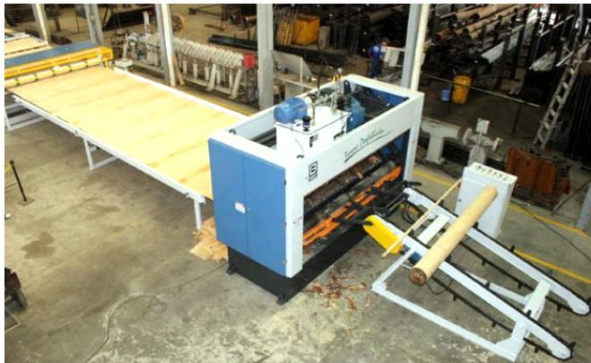
Figura 11 – Torno desfolhador.
