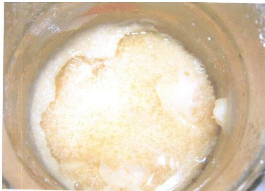
**Figura 13 - Vista superior da cuba do biorreator ao final do cultivo de *P. sajor-caju* em processo descontínuo simples, evidenciando a formação de grandes aglomerados de biomassa micelial.**
