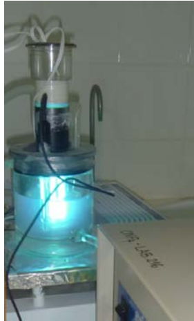
Figura 4. Reator fotolítico usado nos experimentos de fotólise da mistura termodinamicamente estável de óleo diesel.
