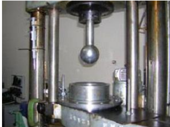
Figura 3.3: Ferramental utilizado para o ensaio Nakajima.
