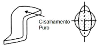
Figura 2.31 – Embutimento ou cisalhamento puro em uma flange de um copo embutido
