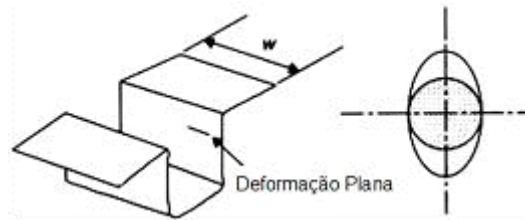
Figura 2.29: Deformação plana na parede de uma peça
