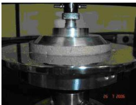
Figura 11 – Ilustração do ensaio de *squeeze-flow*
