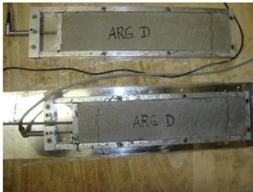
Figura 152 – Detalhe da ruptura da argamassa D no ensaio de retração livre e de retração restringida
