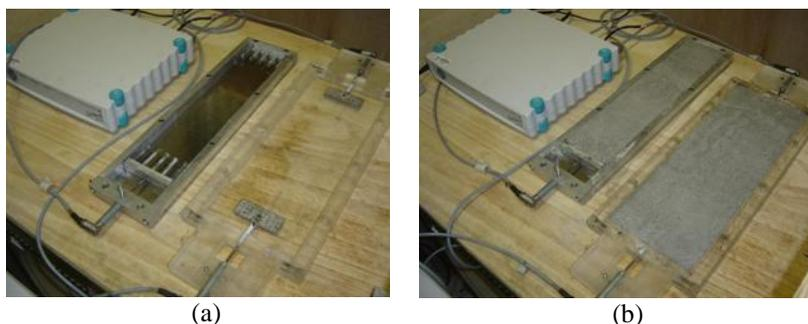
Figura 93 – Ensaio de retração livre linear nos moldes unilateral e bilateral
