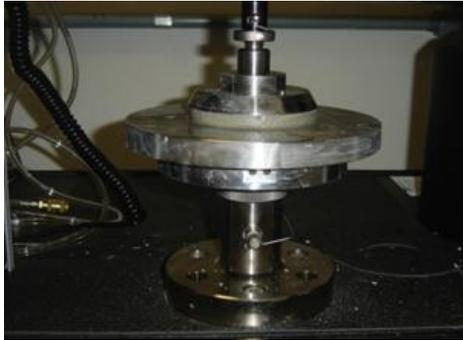
Figura 83 – Ensaio de *squeeze-flow*
