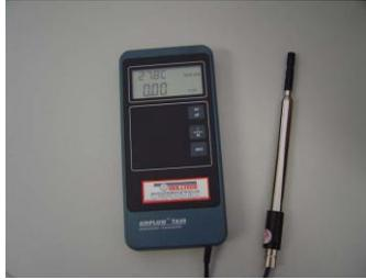
Figura 101 – Anemômetro digital utilizado na medição da velocidade do vento
