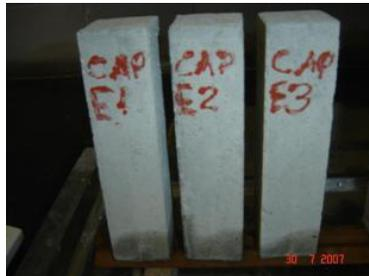
Figura 90 – Ensaio para determinação do coeficiente de capilaridade
