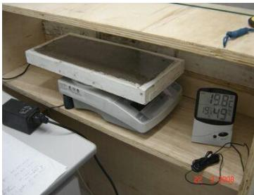
Figura 102 – Ensaio de perda de massa por evaporação da água
