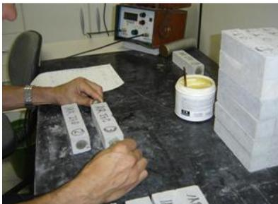
Figura 88 – Ensaio do módulo de elasticidade dinâmica
