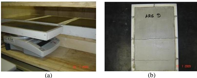
Figura 162 – (a) Ensaio de fissuração e perda de massa nos moldes dentro da caixa e (b) Fissuração do molde número 2 da argamassa D
