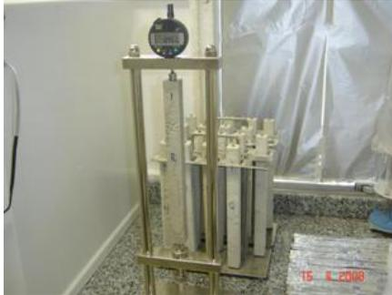
Figura 45 – Relógio comparador utilizado no ensaio de retração por secagem
