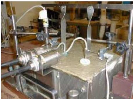
Figura 30 – Ilustração do ensaio de medida de retração plástica de Holt (2001)
