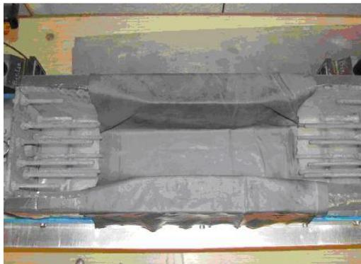
Figura 55 – Detalhes dos pinos de fixação e do feltro utilizado para minimizar o atrito (HAMMER, 2007)
