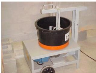
Figura 79 – Misturador planetário de eixo vertical
