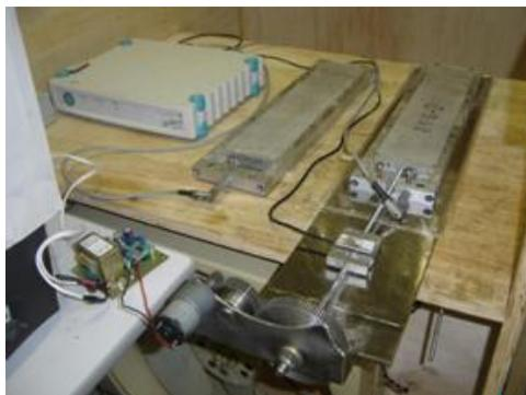
Figura 98 – Ensaio de retração livre e restringida
