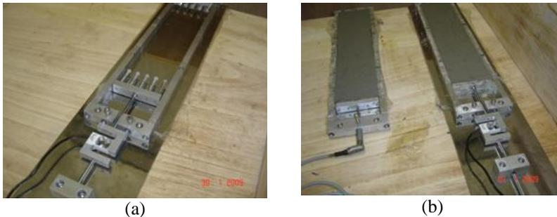
Figura 97 – (a) Molde de aço inox utilizado para obter a força com retração restringida pela célula de carga e (b) Vista dos ensaios de retração livre à esquerda e restringida à direita
