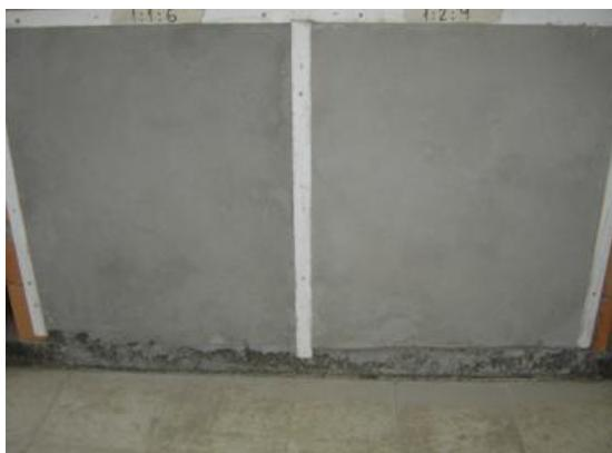
Figura 173 – Vista dos revestimentos de argamassa 1 : 1 : 6 e 1 : 2 : 9 com 35 dias de idade
