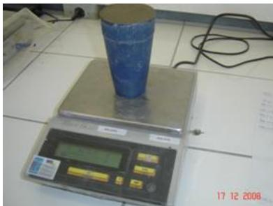
Figura 85 – Ensaio de densidade de massa no estado fresco
