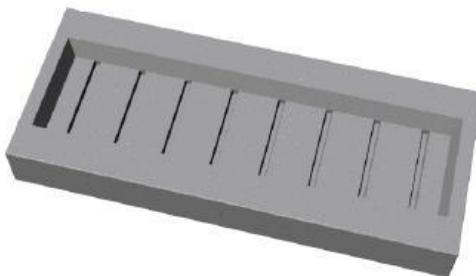
Figura 68 – Molde desenvolvido para avaliar o desempenho de argamassas e concretos de reparos quanto a fissuração (MORENCY et al., 2005)
