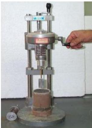
Figura 10 – Equipamento utilizado no ensaio *vane test* (ALVES, 2002)
