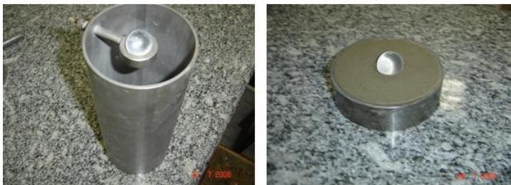
Figura 8 – Ilustração do equipamento do *dropping ball*
