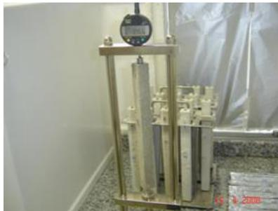
Figura 87 – Ensaio de retração por secagem
