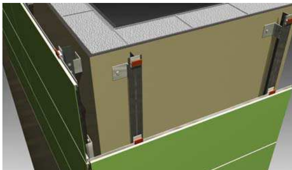
Figura 43 – Fixação das placas. Detalhe: perfis verticais e ancoragens. Fonte: Catálogo técnico Kalebodur (2008).
