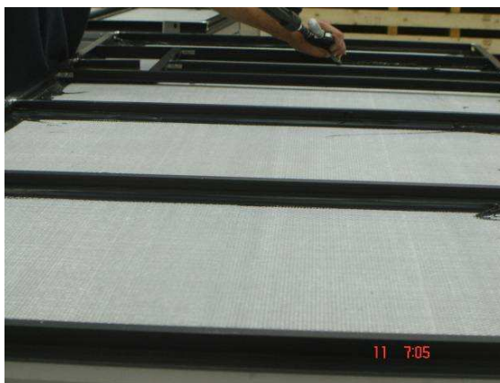
Figura 28 – Formação quadro de alumínio.
