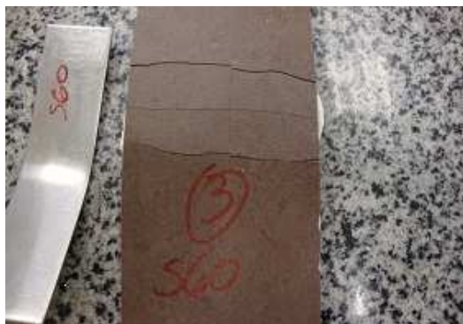
Figura 105 – Teste tração - 3. Fonte: Do autor 2 .
