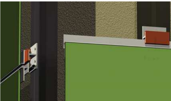
Figura 42 – Fixação das placas por perfis metálicos. Fonte: Catálogo técnico Kalebodur (2008).
