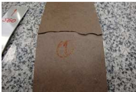
Figura 103 – Teste tração - 1. Fonte: Do autor 2 .
