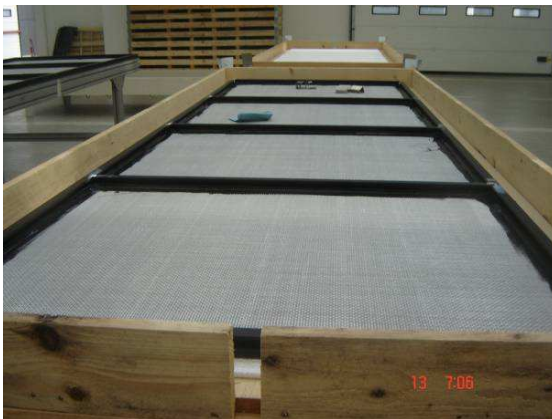
Figura 31 – Quadro de alumínio para placas 3000x1000mm. Fonte: Do autor.
