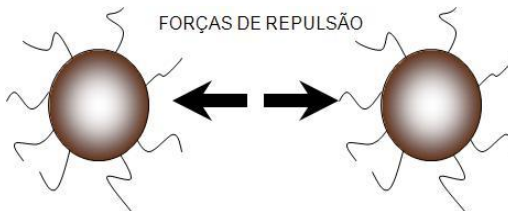
Figura 13 - Mecanismo de estabilização estérica [14] .
