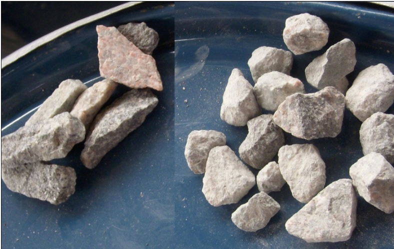
Figura 18 –À esquerda partículas provenientes de um britador do tipo Cone. À direita o mesmo material com apenas uma passagem pelo britador VSI.
