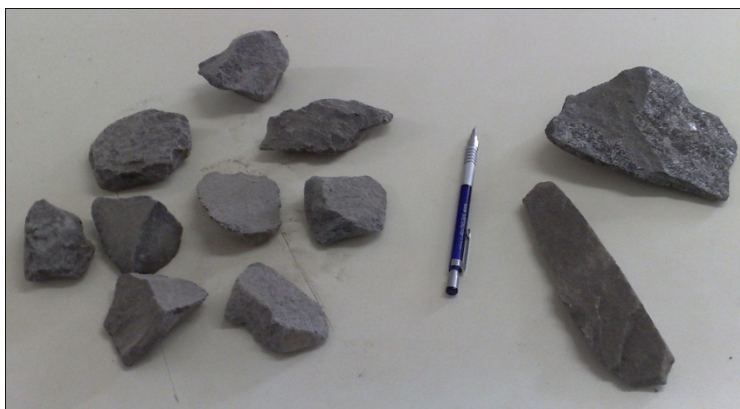
Figura 15 – Comparação entre agregados resultantes das situações de câmara cheia e vazia do Cone, respectivamente.
