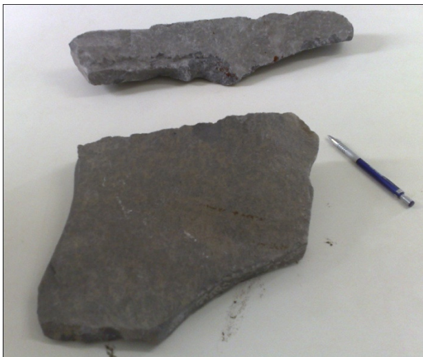
Figura 14 - Exemplo de partículas em forma de agulha e chapa, formadas na situação de câmara parcialmente vazia.
