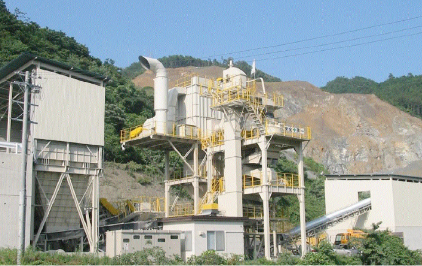
Figura 26 - Sistema para produção de areia de britagem utilizado no Japão (Pettingel, 2008).
