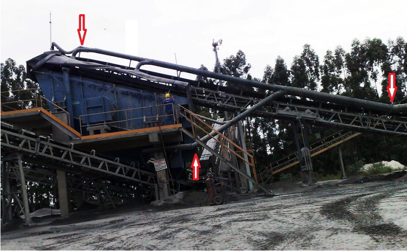
Figura 24 - Tubos para a captação do pulverulento nos pontos de maior concentração.
