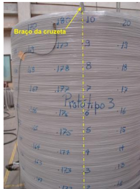
Figura 24 – Detalhe de alguns dos pontos de medição criados para realizar a análise modal do protótipo 3.
