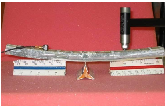
Figura 18 – Posicionamento da amostra com fios a 0^\circ . Módulo de cisalhamento.
