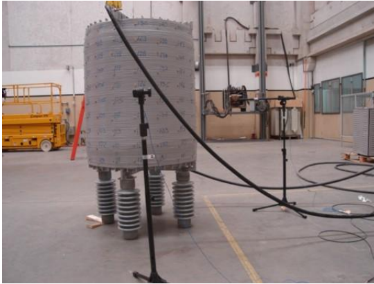
Figura 95 – Medição de ruído no laboratório da AREVA.
