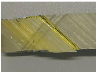
Figura 7 – Região da amostra com fios a 45°, onde ocorreram as fraturas.
