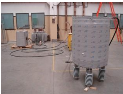
Figura 41 – Protótipo 5 conectado ao circuito elétrico.
