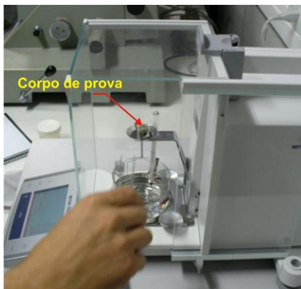
Figura 21 – Determinação da massa do corpo de prova no ar.
