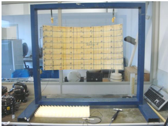
Figura 164 – Casca do protótipo 4 preparada para realização da análise modal experimental.
