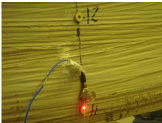
Figura 51 – Detalhe da medição de vibração no ponto 11 usando o vibrômetro LASER e o acelerômetro.
