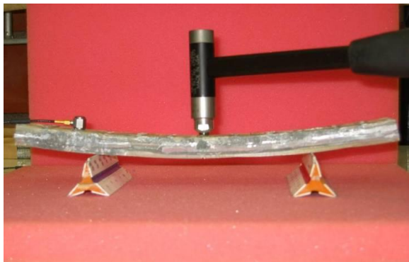
Figura 17 – Posicionamento da amostra com fios a 0^\circ . Módulo de elasticidade.
