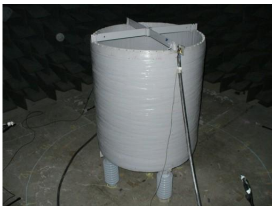
Figura 94 – Medição de ruído na câmara semi-aneecóica.
