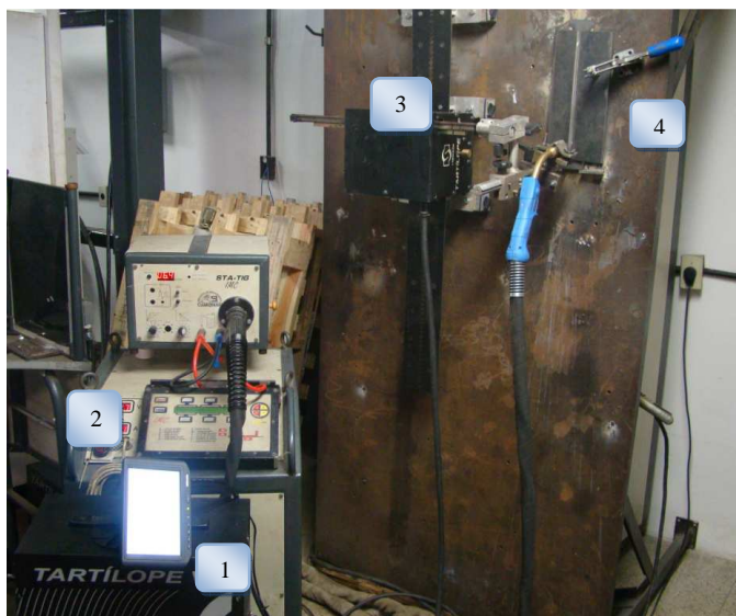
Figura 52 - Equipamentos da bancada de simulação da soldagem naval
