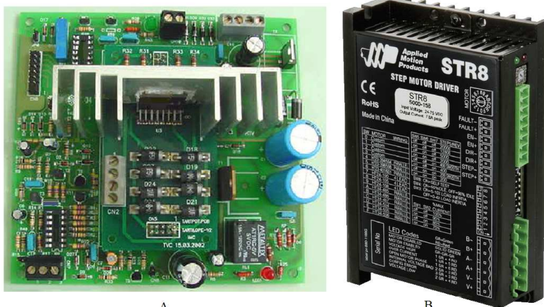
Figura 46 - Drivers motor de passo; em A o Antigo driver Tartilope V2F [10] e em B o driver STR8 [32]
