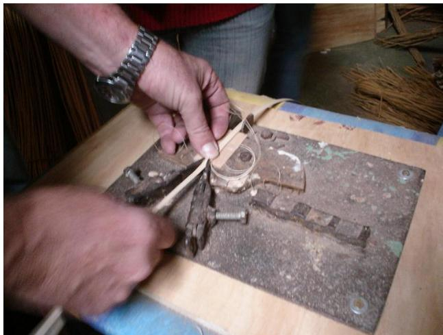
Figura 33: Utilização do refilador para uniformizar tiras de fibras.
