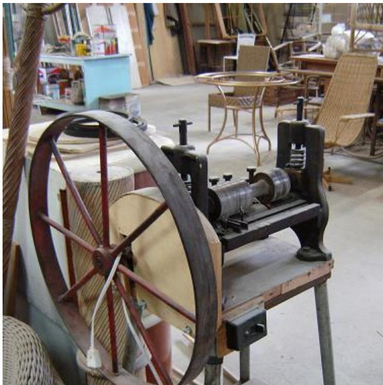
Figura 29: Máquina de passar vime da fábrica Schulz.
