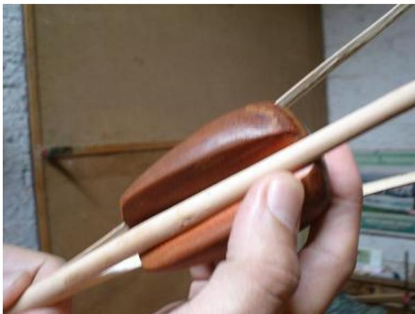
Figura 32: Utilização do rachador para abrir as hastes de vime.
