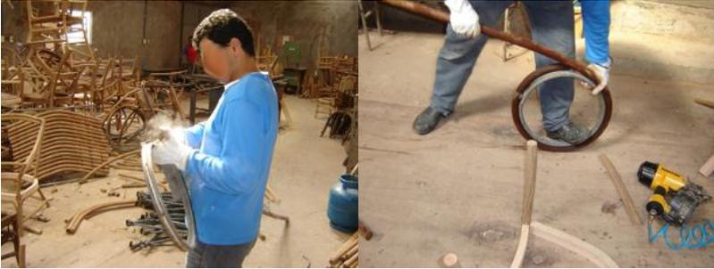
Figura 38: Curvatura de estruturas em apuí a partir de moldes.
