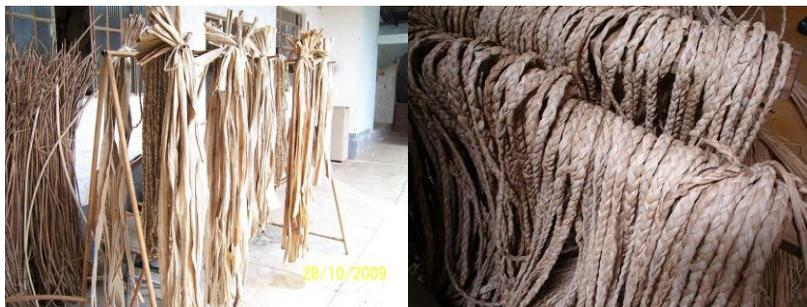
Figura 52: Processo de secagem e preparo de fibras da bananeira.
