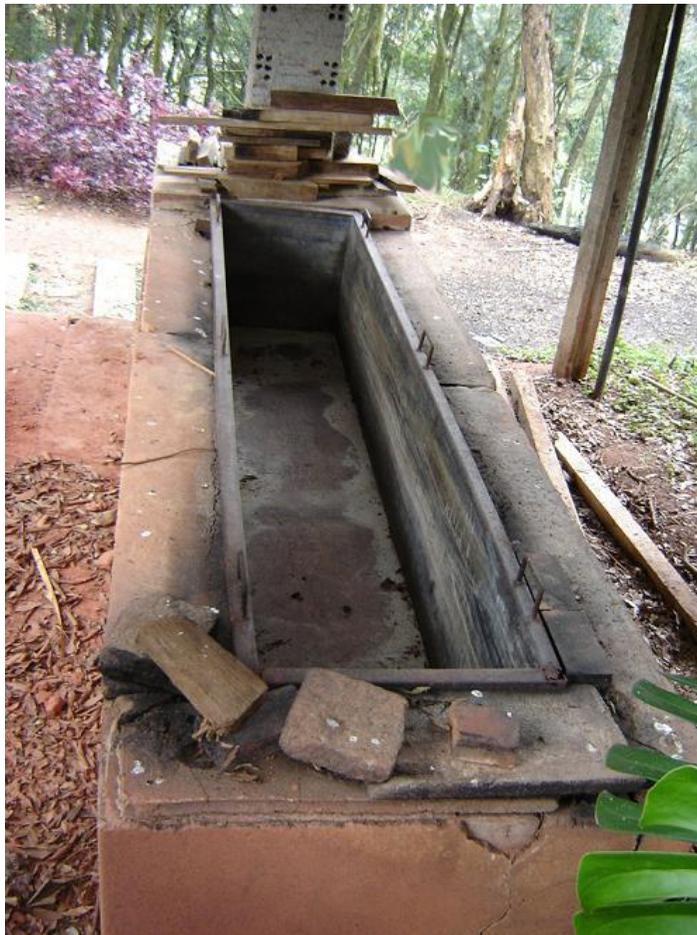
Figura 30: Tacha para cozimento de fibras naturais.
