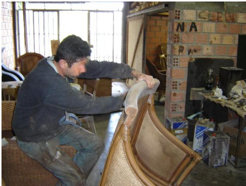
Figura 46: Foto de acabamento e pintura - lixamento.
