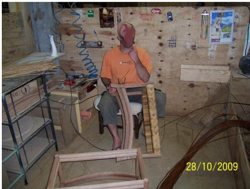
Figura 42: Execução do trançado de peças em fibras.
