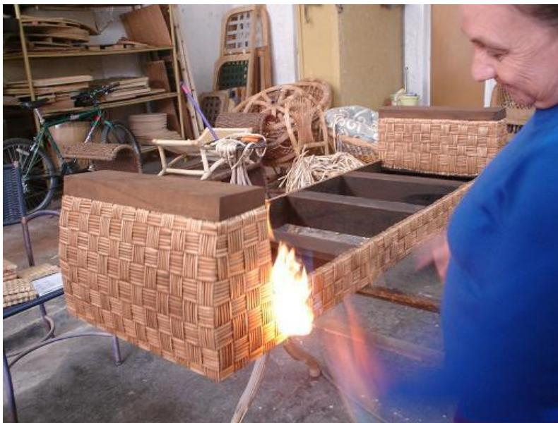
Figura 43: Execução de acabamento de peças em junco, com maçarico.
