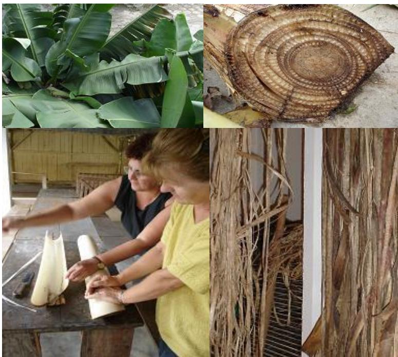
Figura 51: Etapas do processo de transformação da fibra da bananeira.
