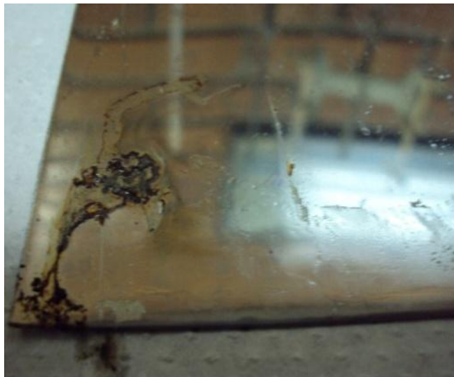
Figura 25. Face traseira amostra 1 430 com verniz após ensaio cíclico.
