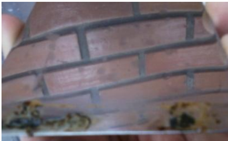
Figura 22. Amostra 2 aço 430 sem verniz após ensaio cíclico.
