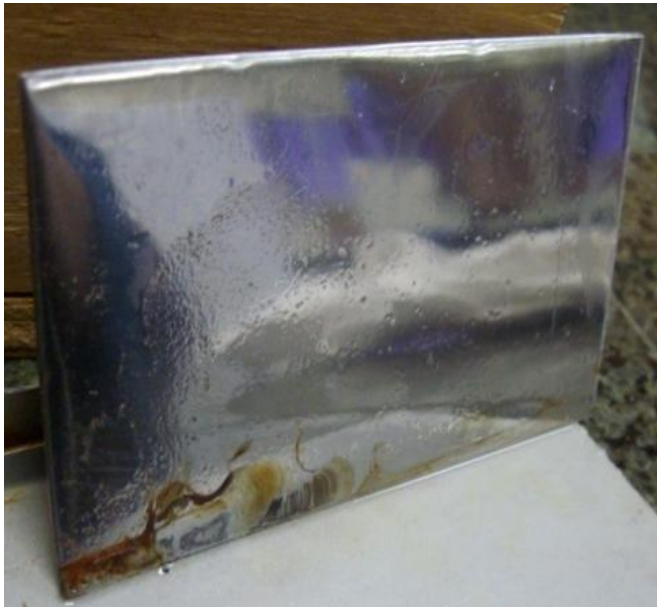
Figura 44. Face traseira da amostra de aço 430 com verniz, onde não havia presença de verniz, após o teste de névoa salina.
