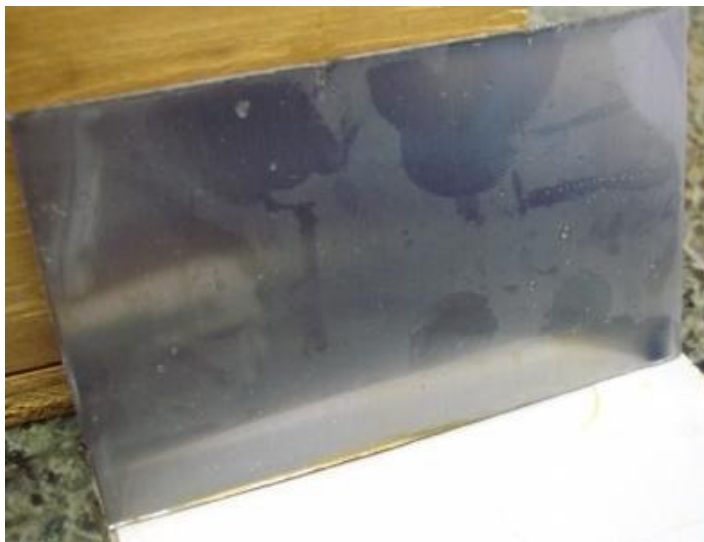
Figura 42. Amostra 1 aço 430 com verniz após 240h de névoa salina.
