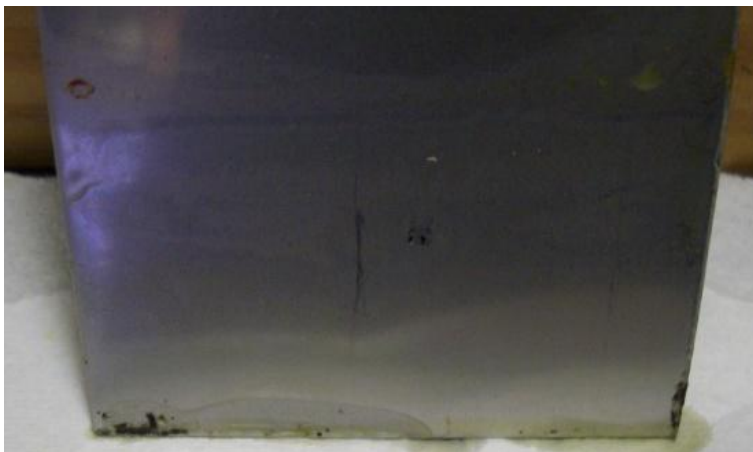
Figura 37. Amostras do aço 304 após 60h de imersão.
