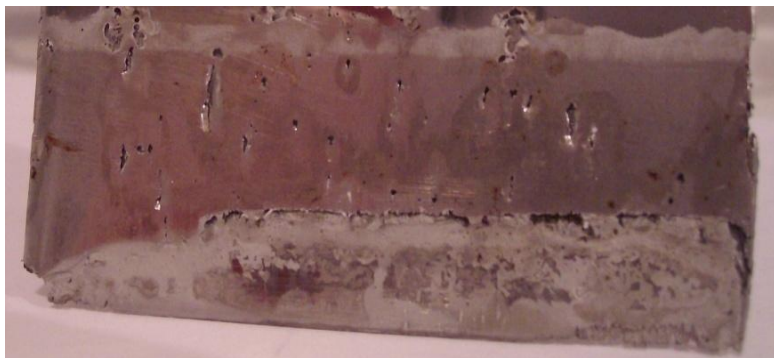
Figura 33. Corrosão no aço 430 sem verniz após a limpeza da amostra.
