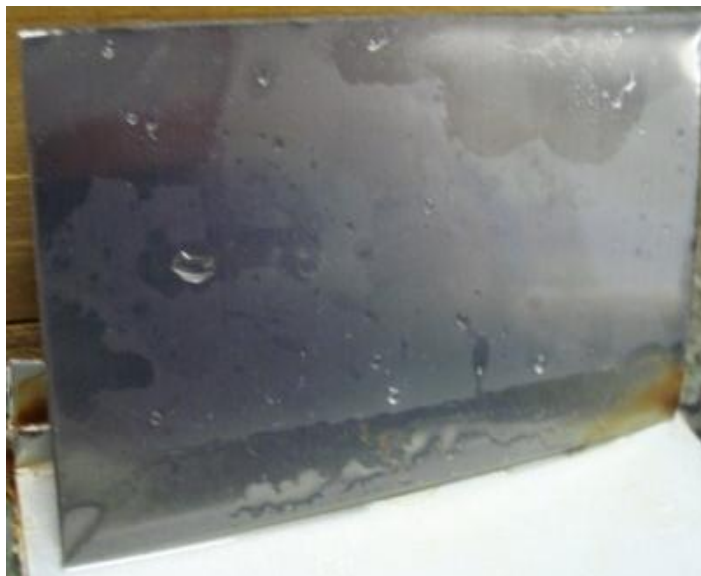
Figura 43. Amostra 2 aço 430 com verniz após 240h de névoa salina.
