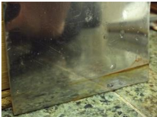
Figura 40. Amostras aço 430 sem verniz após 240h de névoa salina.
