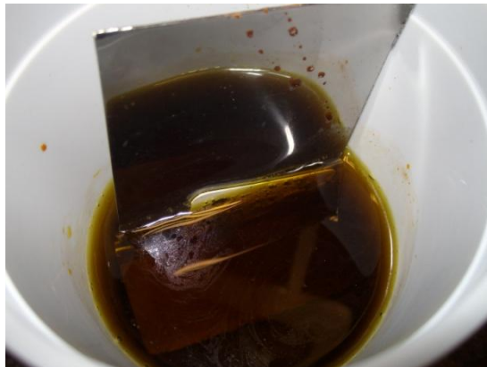
Figura 20. Amostra imersa em solução de cloreto férrico.
