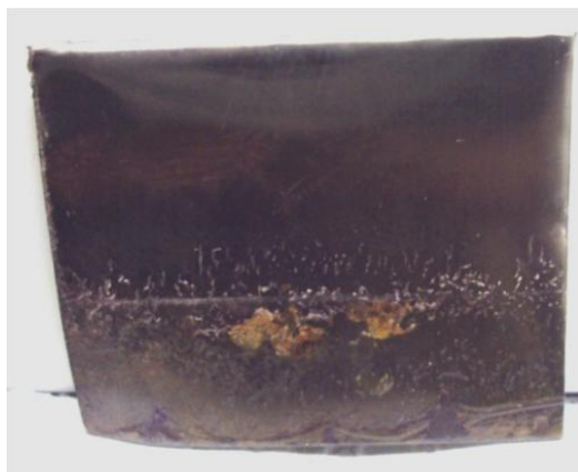
Figura 54. Foto região amostra 2 caracterizada via MEV após ensaio de névoa salina.
