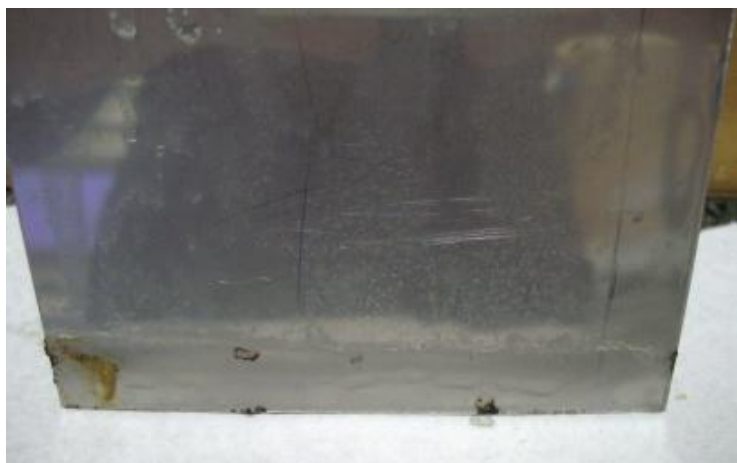
Figura 27. Amostra 2 aço 304 após ensaio cíclico.
