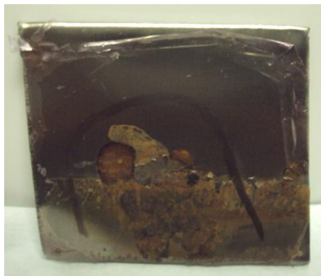
Figura 59. Região amostra 1 caracterizada via MEV após ensaio cíclico.
