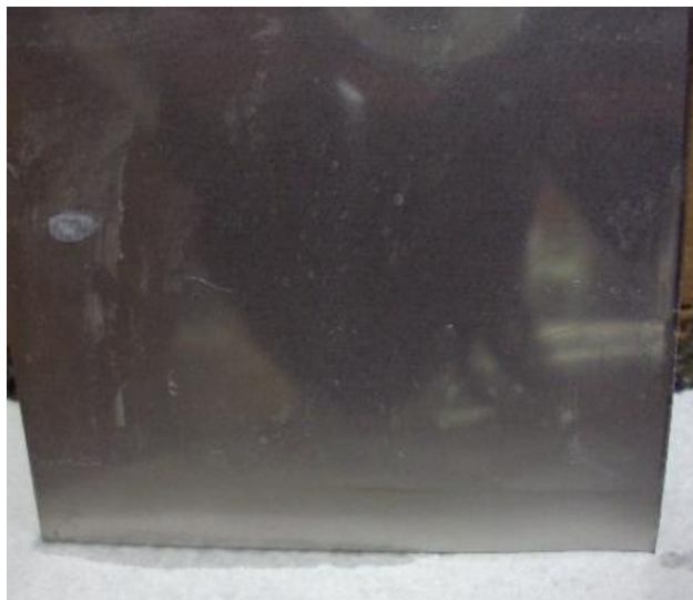
Figura 45. Amostra 1 aço 304 após 240h de névoa salina.
