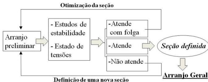
Figura 37: Fluxograma dos estudos de estabilidade de BGC para a definição da seção (adaptado de Gutstein,2003).
