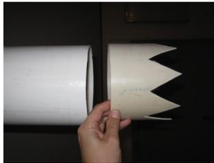
Figura 3.11: Terminação tipo bocal dentado.
