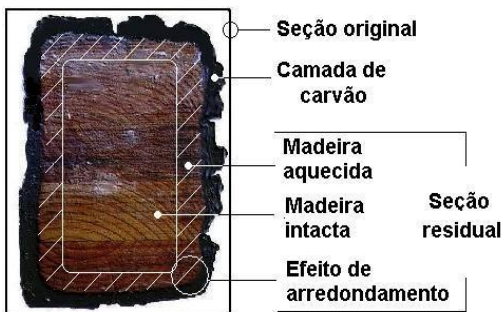
Figura 8- Seção residual de viga após 30 minutos de exposição ao fogo. Fonte: Pinto, 2004
