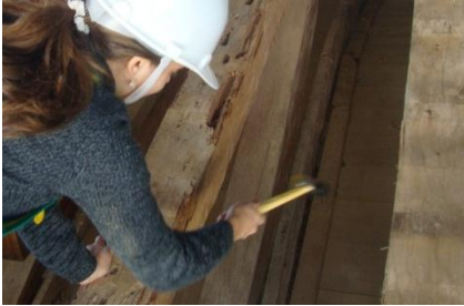
Figura 30 - Inspeção através de método não destrutivo tradicional utilizando martelo de borracha. Fonte: autora, 2010
