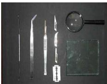
Figura 33 – Instrumentos utilizados para a prospecção da madeira. Fonte: Nunes (2006)
