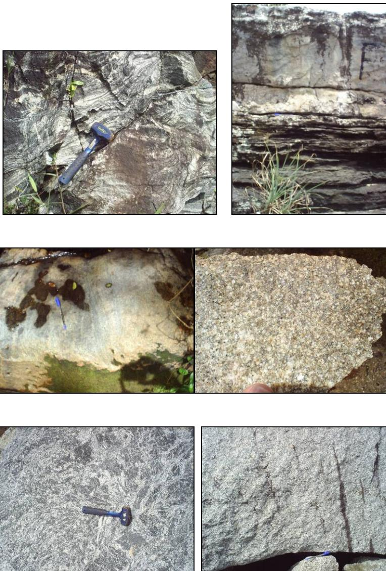
Figura 10: Rochas identificadas no município de Itapema. A - Rocha Gnaiss do Complexo Camboriú, B - Rocha metassedimentar do Complexo Metamórfico Brusque, C - Granitóides Sintectônicos, D - Granito Itapema, e E - Leucogranito.
