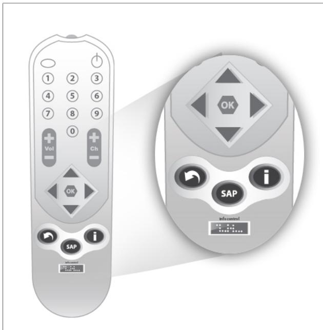
Figura 41 - Controle Remoto e Botões de Acessibilidade (retorno, tecla SAP, interatividade e informação das funções do controle)
