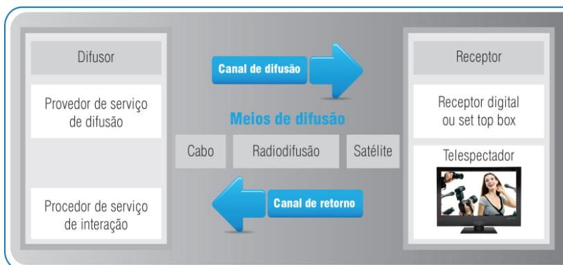
Figura 11 - Modelo de um Sistema de TVDI.
