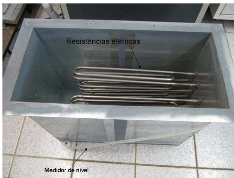
Figura 27 – Gerador de vapor.
