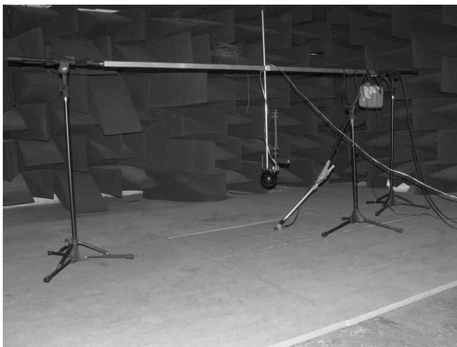
Figura 166: Medição na câmara semi-anecóica com o *baffle* feito de MDF.
