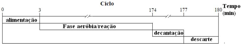
Figura 12 - Distribuição dos ciclos de operação do reator RBSI.
