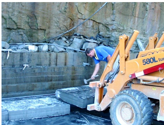
Figura 3.4: Retirada dos blocos da pedreira.
