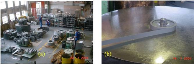
Figura E.3 - Núcleo de TC, a) montagem de núcleos; (b) Enrolamento do núcleo [1].
