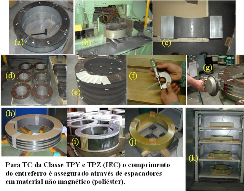
Figura E.5 - Processo de fabricação do núcleo com entreferro [9].
