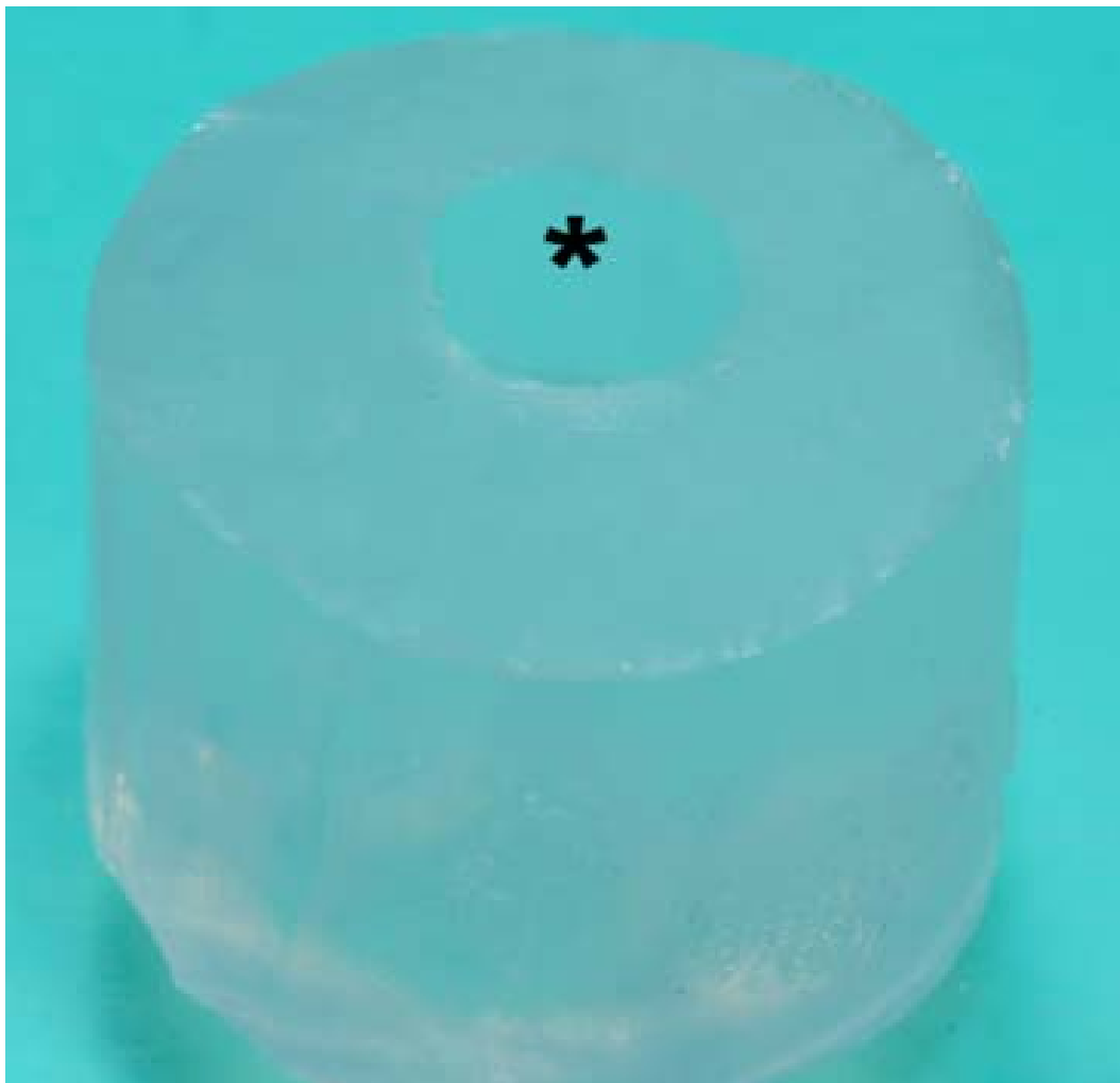
Figura 3 – Matriz de silicone contendo molde interno (*) de 13mm de altura e 8mm de diâmetro.
