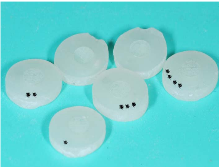
Figura 10 – Corpos-de-prova para ensaio de push-out .
