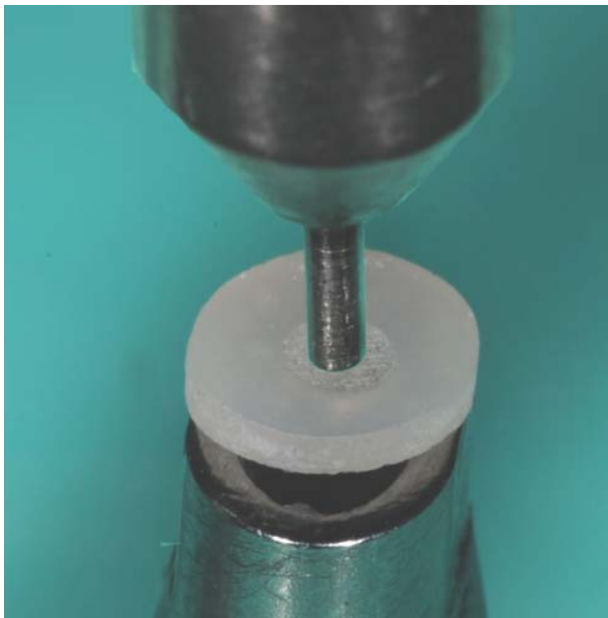
Figura 11 – Aplicação da carga para o teste de cisalhamento.
