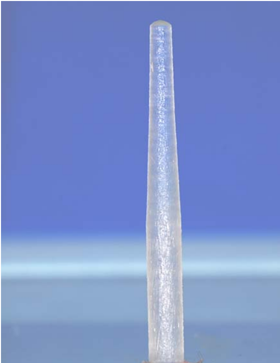
Figura 4 – Pino de fibra de vidro fixado na placa de vidro com adesivo à base de cianoacrilato (Super Bonder, Loctite).
