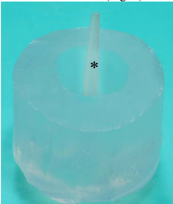
Figura 5 – Matriz de silicone contendo o pino de fibra de vidro (*) centralizado no molde.
