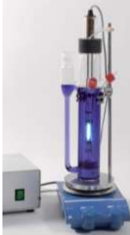
Figura 6: Reator utilizado na cinética de fotodegradação catalítica
