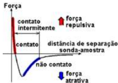
Figura 3.3 Gráfico de força interatômica vs. distância entre a sonda e a amostra. Figura extraída de [28].
