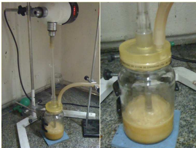
Figura 17 - Esquema ilustrativo do misturador mecânico a vácuo utilizado para a mistura dos componentes do compósito.
