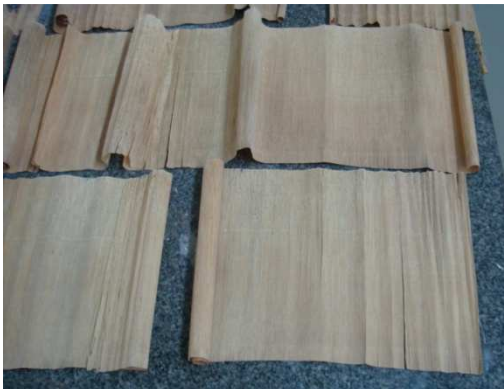
Figura 16 – Laminados torneados de bambu extraídos por um dispositivo desenvolvido e construído no laboratório.
