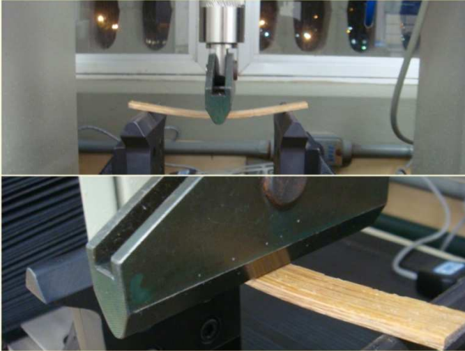
Figura 24 – Ensaio de flexão no modo “flexão em três pontos”, que consiste em aplicar a força de flexão no centro do corpo de prova através de um cutelo até o mesmo romper-se ou deformar-se a um determinado valor
