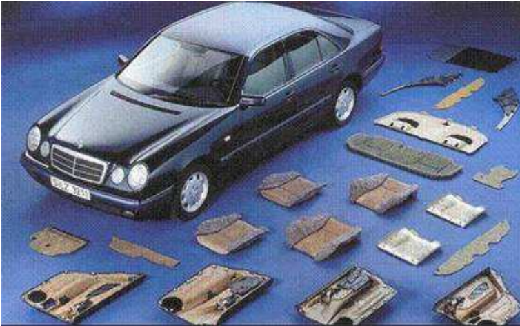
Figura 1 – Painéis, tampos e revestimentos internos utilizados no automóvel Classe E da Mercedes-Benz produzidos com material polimérico reforçado com fibras vegetais, como linho e sisal
