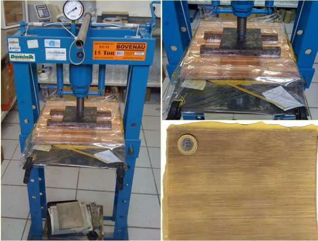
Figura 20 – Prensa utilizada para a compressão e moldagem dos laminados de bambu e resina formando as chapas de material compósito.
