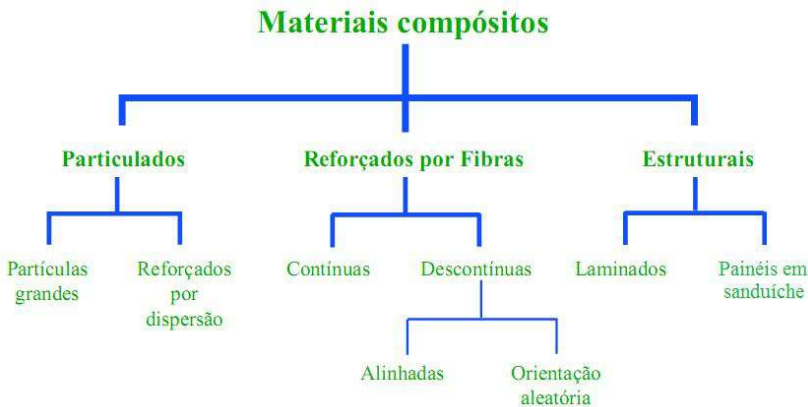
Figura 2 – Esquema de classificação de materiais compósitos, segundo a geometria da fase dispersa.
