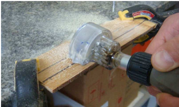
Figura 21 - Ilustração do método usado para cortar os corpos de prova de um compósito.
