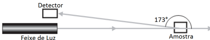
Figura 3.3: Esquema da detecção da luz espalhada pela amostra na análise de DLS
