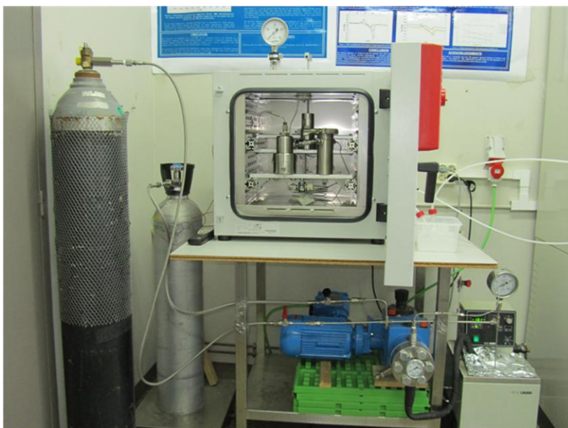
Figura 4.7: Fotografia do sistema experimental utilizado para dessorção supercrítica.
