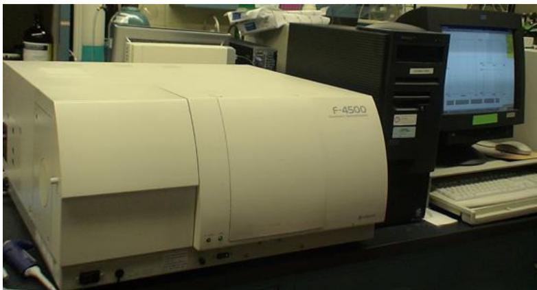
**Figura 27.** Espectrofluorímetro Hitachi F-4500 usado na obtenção dos espectros de fluorescência do estado estacionário do pireno nas soluções aquosas contendo polímeros e surfactantes.
