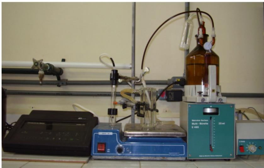
**Figura 26.** Condutivímetro ATI ORION modelo 170 e bureta semi-automática Metrohm Herisau usado nas titulações condutivimétricas.
