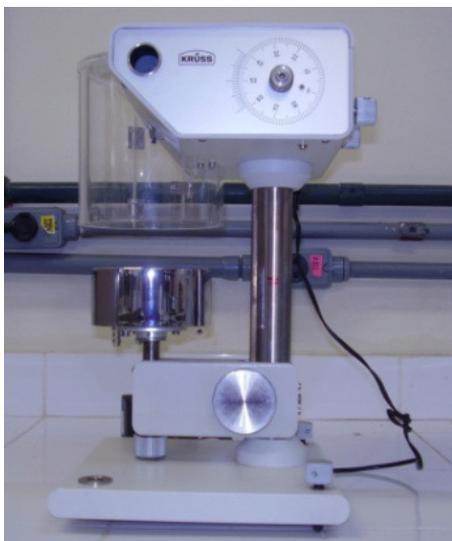
**Figura 25.** Tensiômetro KRUSS GMBH, modelo K 8 usado na determinação da tensão superficial das soluções aquosas contendo polímero e surfactantes.
