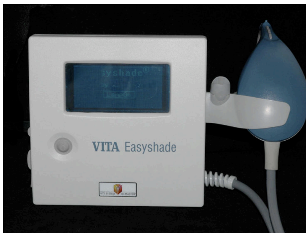
Figura 2 – Espectrofotômetro Vita EasyShade (Vita-Zahnfabrik) utilizado para a avaliação instrumental da cor.
