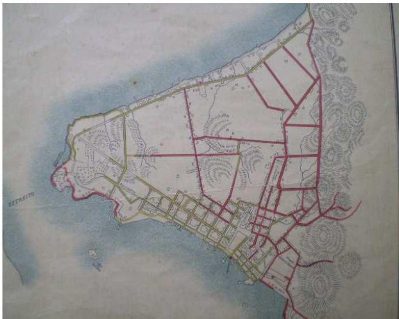
Figura 5 - Planta da rede de esgotos de Florianópolis (1913). Em vermelho aparecem as ruas por onde existia canalização de esgoto. Observa-se que muitas das atuais ruas já haviam sido abertas, como a Rio Branco e a Presidente Coutinho; transversais no centro da planta (IPUF).
