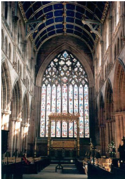
Figura III - Vista interna dos vitrais da Catedral de Carlisle/UK, fundada em 1122. A coloração dos vitrais é decorrente da adição de nanopartículas de ouro, prata e cobre ao vidro. Fonte: ( http://marcanc.com/viagens/sq200309/sq2003set_carl.html ).
