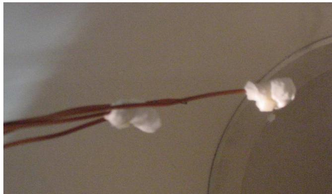
Figura 37 – Fotografia do Termopar com bulbo úmido para medição de TBU.
