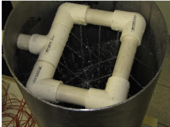
Figura 36 – Fotografia da tubulação de entrada de água quente na torre.
