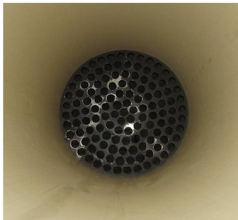
Figura 29 – Fotografia do retificador dentro da tubulação.
