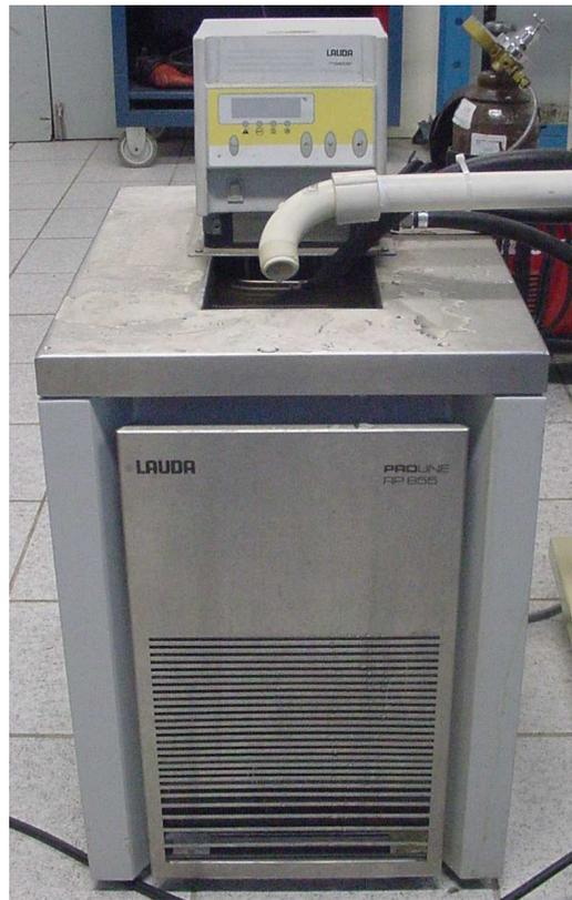
Figura 34 – Fotografia do Banho térmico da Lauda modelo Proline RP855.
