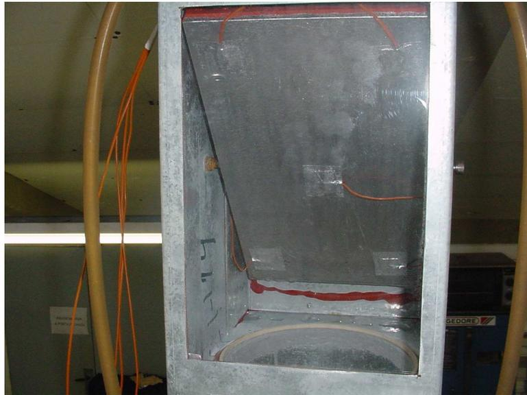
Figura 43 – Fotografia do dispositivo para desumidificação/condensação e recolhimento da água.
