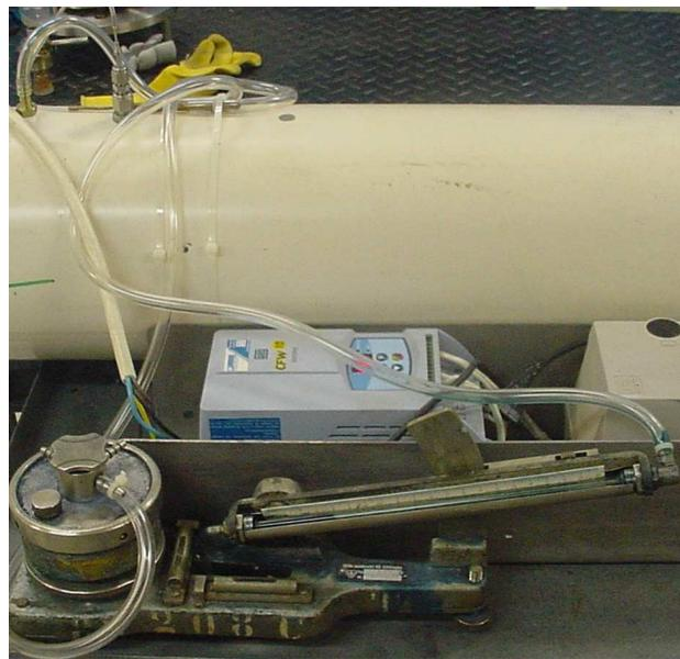
Figura 32 – Fotografia do manômetro utilizado para medir pressão dinâmica do fluxo de ar.
