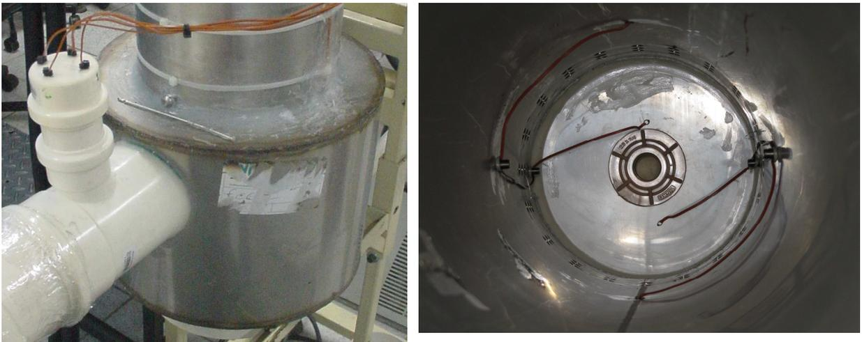
Figura 49 – Fotografia dos termopares de medição de TBS e TBU do ar de entrada (1 a 4) à esquerda e de saída de água quente (11 e 12) na bancada, à direita.
