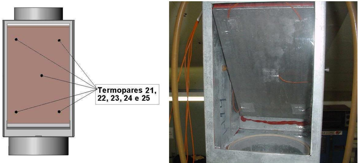
Figura 52 – Posição e fotografias dos termopares na placa de desumidificação (21 a 25).
