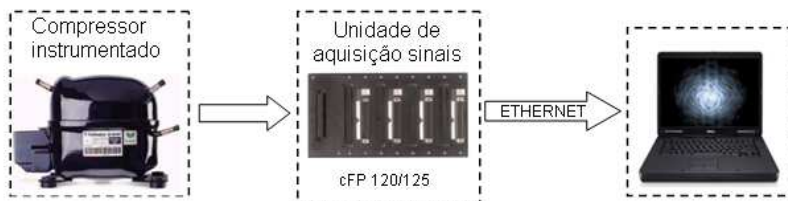
Figura 56- Cadeia de medição temperaturas do compressor.
