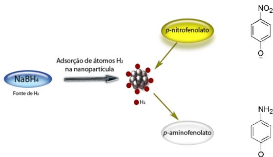
**Figura 10.** Esquema da redução do pNF para pAF.
