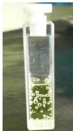
**Figura 48.** Cubeta da reação de redução do pNF para demonstrar a formação de bolhas resultante da liberação de  $H_2$ .
