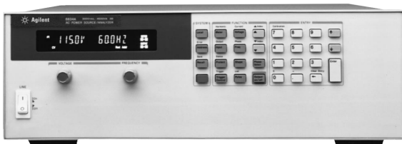
Figura 3.1: Fonte Agilent 6812B utilizada em diversos ensaios com injeção de CC.
