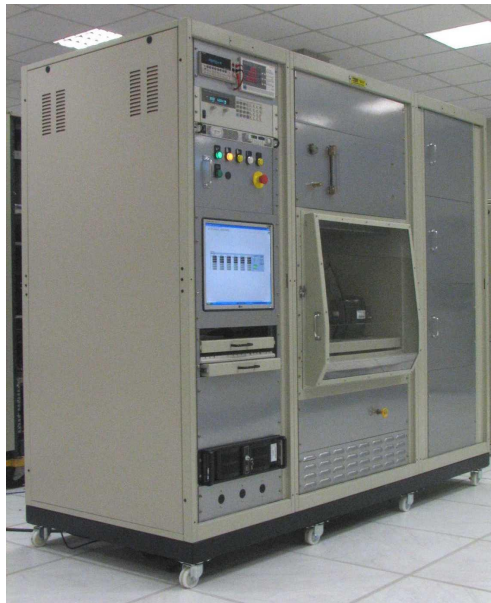
Figura 1.3: Foto de uma bancada de ensaios de desempenho.
