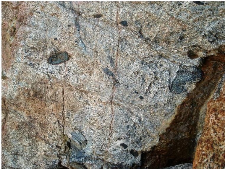
Figura 120 -Rocha encontrada no escorregamento 3. Trata-se de gnaíse granulítico contendo numerosos enclaves máficos com diferentes graus de assimilação. Foto: Fernanda Bauzys (2009).
