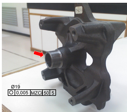
Figura 87 – Carcaça de compressor utilizada no ensaio. Fonte: Autor.
