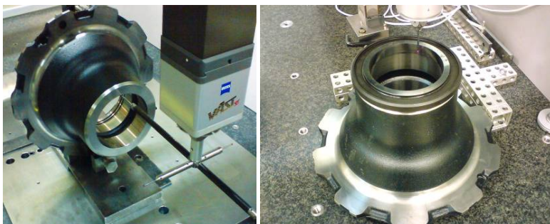
Figura 77 – Medição do cubo de eixo na MMC da empresa (à esquerda) e na calibração (à direita). Fonte: Autor.
