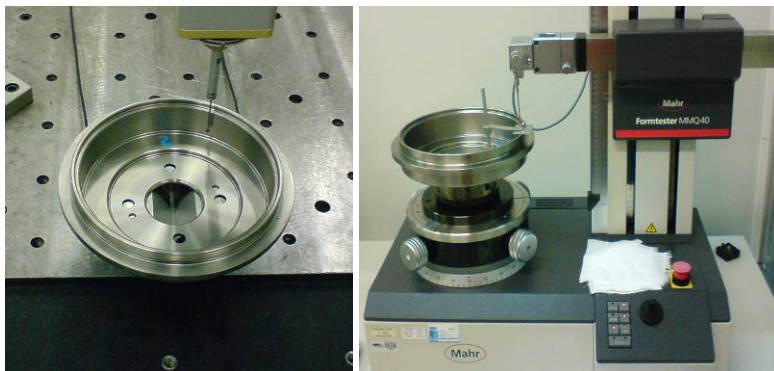
Figura 68 – Medição do tambor de freio na MMC da empresa (à esquerda) e na calibração (à direita). Fonte: Autor.
