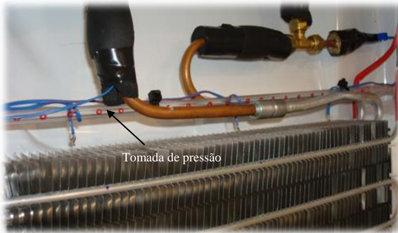
Figura 5.5 – Termopares e tomada de pressão na região de saída
