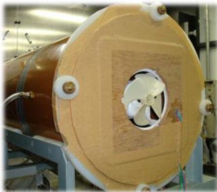
Figura II.6 – Montagem do ventilador do refrigerador no túnel de vento
