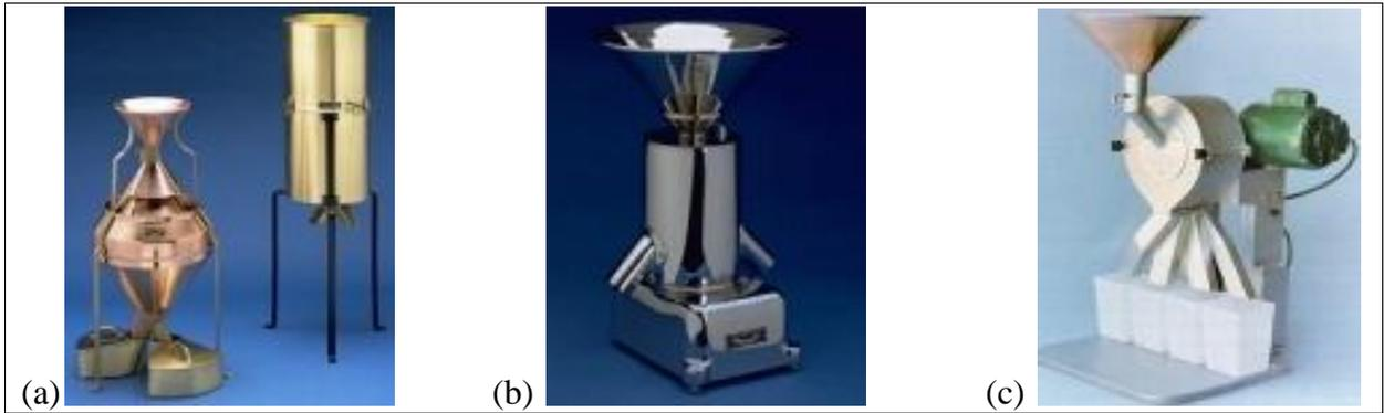
**Figura 11.** Tipos de divisores de amostras: (a) divisor de Boerner e cargo; (b) divisor de precisão elétrico e (c) divisor de Gamet
