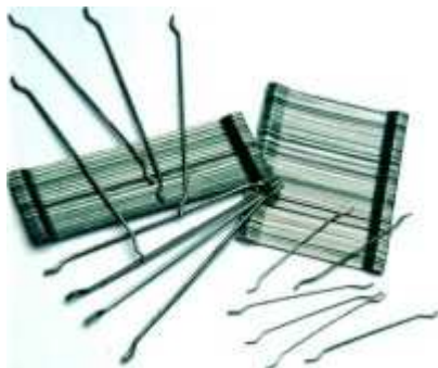
Figura 2.17 – Exemplo de fibras de aço
