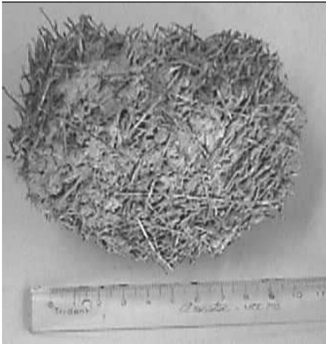
Figura 2.18 – Ouriço formado por fibras de aço mal misturadas ao concreto
