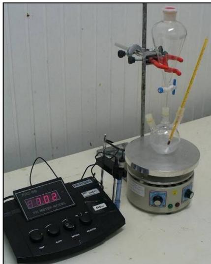
**Figura 9.** Unidade experimental de obtenção dos nanocristais de ZnO.
