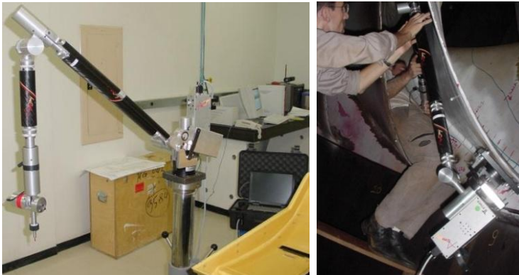
Figura 1-2 – Braço de medição portátil e sua utilização em campo.
