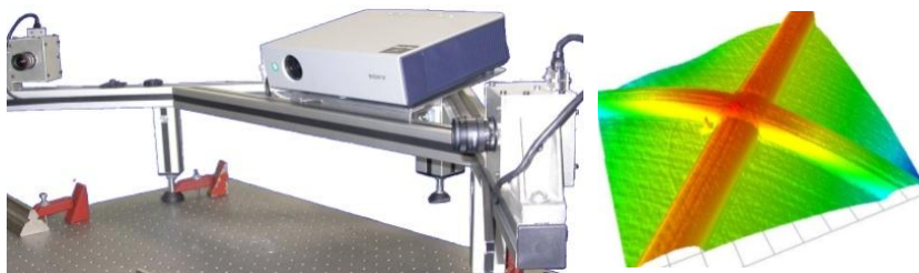
Figura 1-3 – Sistema de medição óptico e uma nuvem de pontos medida.
