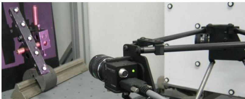
Figura 4-15 Padrão unidimensional sendo medido para avaliação segundo guia VDI/VDE 2634-1.
