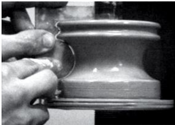
Figura 2-24 – Chapelona para verificação de forma em isolar elétrico.
