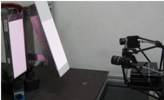
Figura 4-31 Sistema medindo um plano que pode ser inclinado com ângulos conhecidos.
