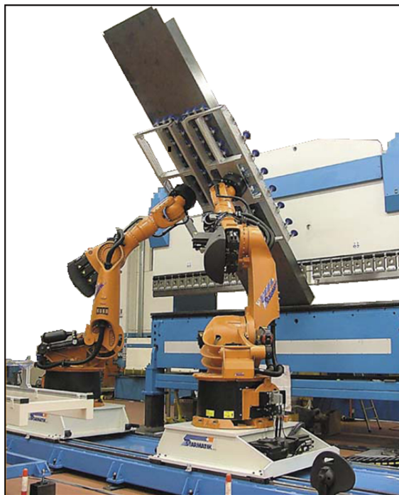
Figura 11: Cooperação para dobramento de chapas grandes (STARMATIK, 2007)
