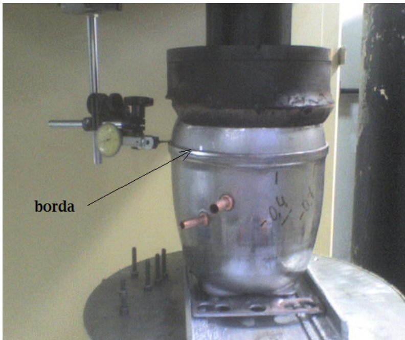
Figura 37: Ilustração da medição da variação da altura da borda da carcaça.
