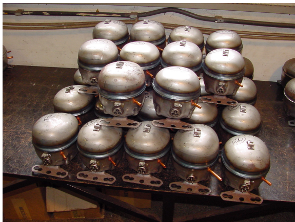
Figura 46: Aspecto geral dos compressores soldados.
