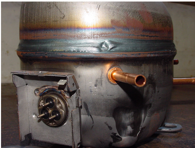
Figura 55: Amostra 9, descontinuidade no órgão de solda.
