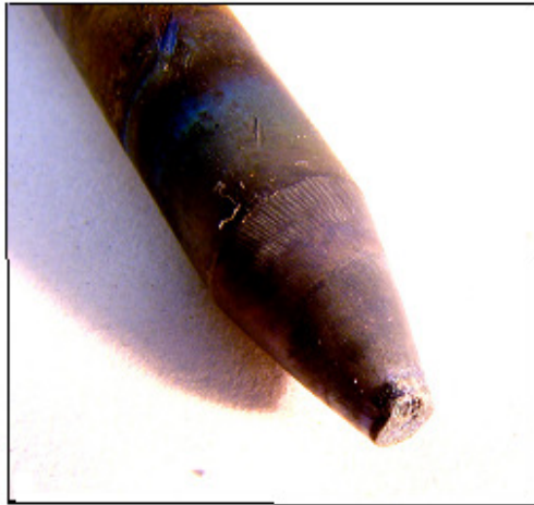
Figura 49: Aspecto do eletrodo após 30 carcaças soldadas com Ar + 10% H_2 .
