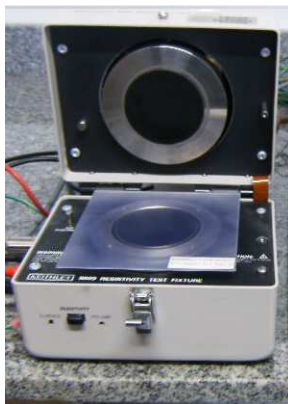
Figura 17 - Sistema utilizado para a medida padrão dois pontos, Eletrômetro e célula de medida Keithley mod. 8009.
