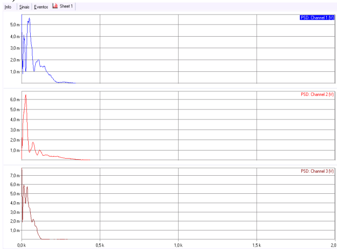
Figura 18- Gráfico dos sinais ( x , y e z ) gerados no tornozelo durante uma queda, no domínio da frequência ( V^2/Hz ), após análise espectral realizada pelo programa AqDAnalysis 7.0.
