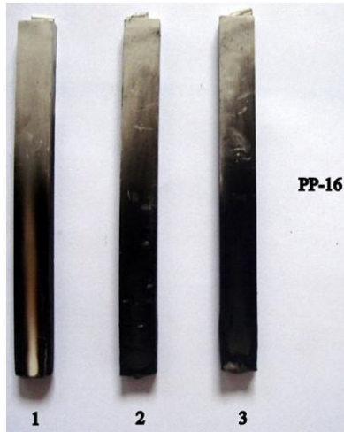
Figura 5. 7 - Ensaio para classificação UL 94 nos corpos de prova PP-16
