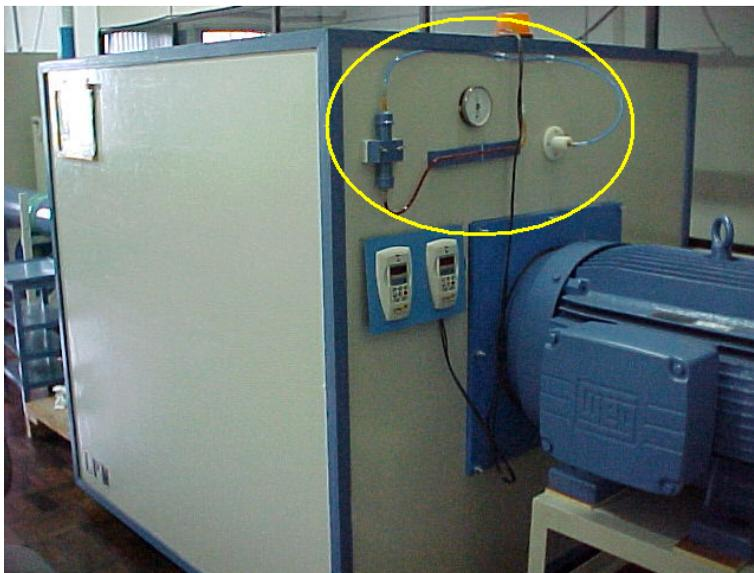
Figura 5.3 – Detalhe do ajuste de pressão da câmara de estabilização.
